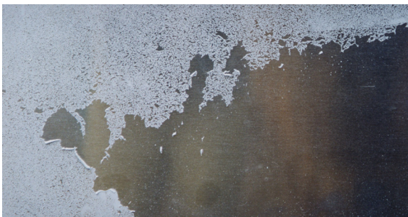
Abb. 3.8.1 Großflächige Fehlstellen ohne Ausprägung einer Lackschicht Handschweiß, Handcreme, ...
