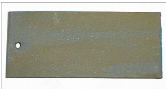
Abb. 1.3.5 Korrosion durch Fe-Phosphatierung auf gestrahlten Teilen
