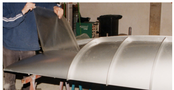
Abb. 5.2.4 Keine oder schlechte Zwischenhaftung
