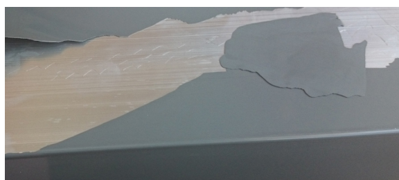
Abb. 1.1.5 Konversionsschicht zu dick
