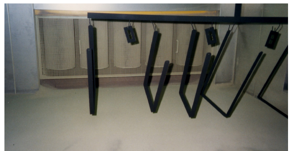
Abb. 6.1.2 Pulververschleppung von einer zur anderen Kabine
