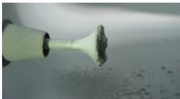
Abb. 2.2.2 Ansinterung an Pralltellerdüse
