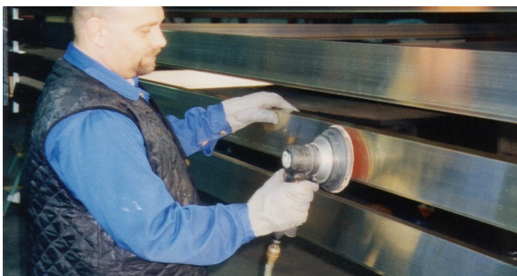
Abb.3.5.1 Verunreinigung der Lackoberfläche durch Schleifarbeiten
