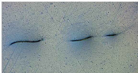
Abb. 3.5.2 Fasern, Flusen von Reinigungstüchern und Arbeitskleidung
