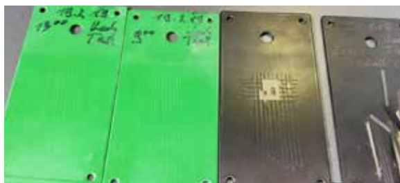
Fig. 1.1.4 Couche de conversion pas assez épaisse
