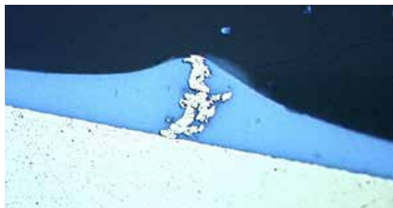
Fig. 3.5.4 Copeaux dans le revêtement
