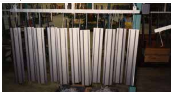
Fig. 2.4.2 Positionnement des pièces incorrect
