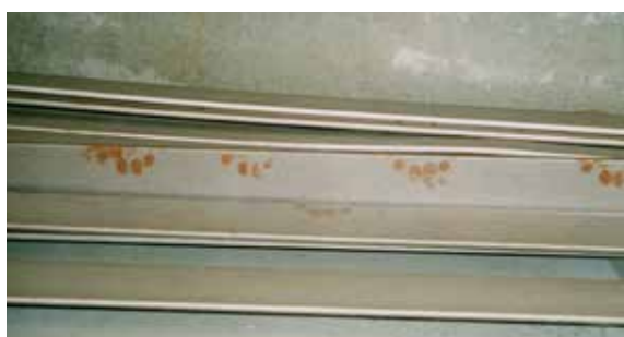
Fig. 3.8.2 Contamination des pièce par de la sueur, de la crème pour les mains, ...
