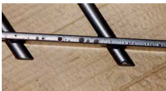
Fig. 3.2.4 Cratères dans le film poudre liés à la corrosion
