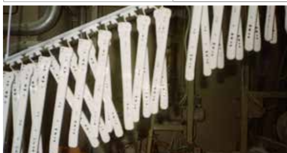
Fig. 2.4.1 Positionnement des pièces incorrect
