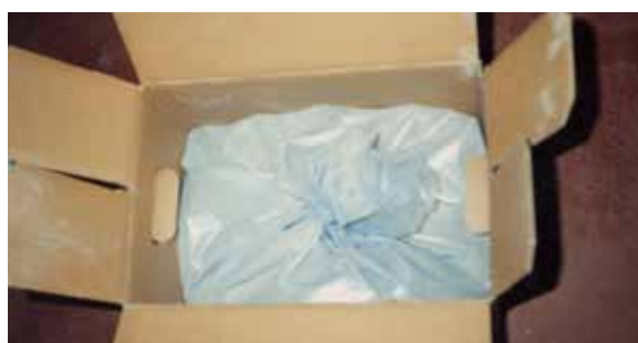
Fig. 3.5.6 Contamination lors du stockage de la poudre
