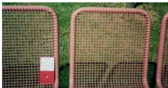
Fig. 5.1.1 Résistance aux détergents insuffisante
