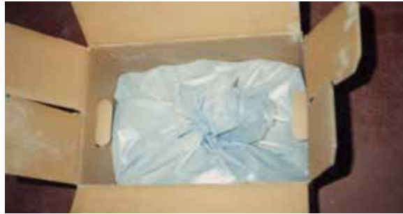
Fig. 3.5.6 Contaminación al almacenar el recubrimiento en polvo
