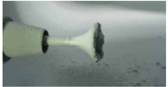
Fig. 2.2.2 Proporción de partículas de polvo fino demasiado elevada, sustituir con «Sinterizado en molino de impacto»
