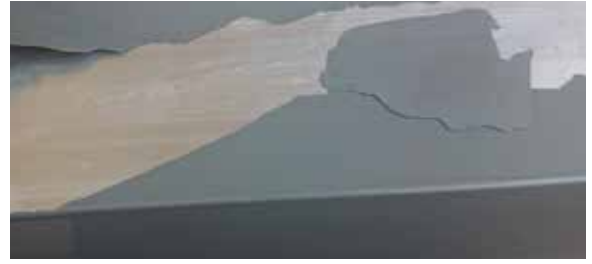
Fig. 1.1.5 Capa de conversión demasiado gruesa
