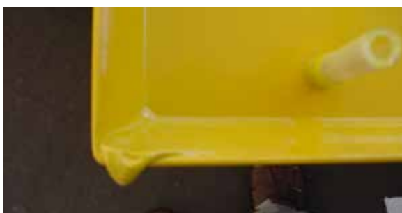
Fig. 3.7.1 Espesor demasiado elevado
