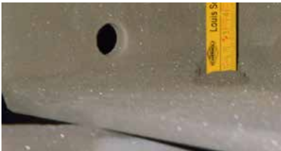
Fig. 2.3.5 Capa de polvo demasiado gruesa
