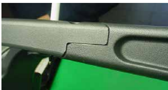
Fig. 7.3.1 Desviaciones claro-oscuro en piezas de trabajo
