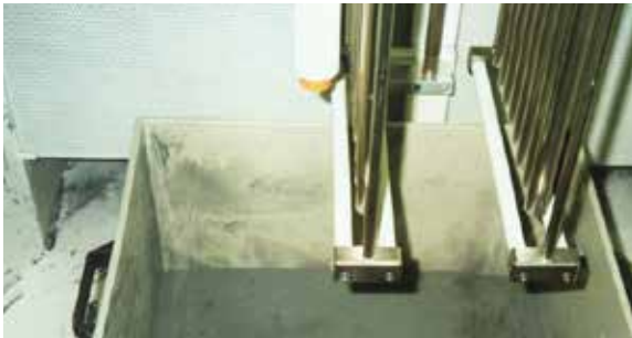
Fig. 2.1.1 Fluidización: el polvo debe fluir como el agua
