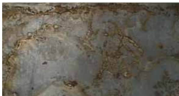
Fig. 1.3.4 Enjuague pobre, material almacenado húmedo
