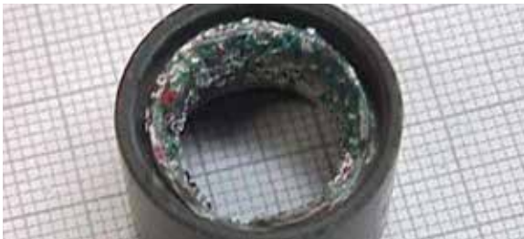
Fig. 2.2.5 Material de manguera no adecuado
