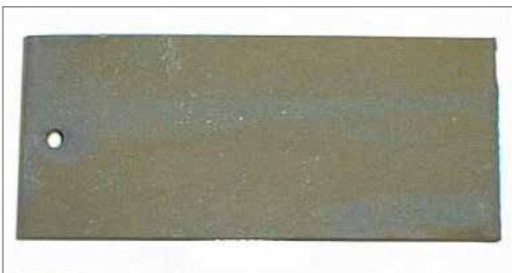
Fig. 1.3.5 Corrosión debida al recubrimiento de fosfato de hierro en piezas tratadas con chorro de arena
