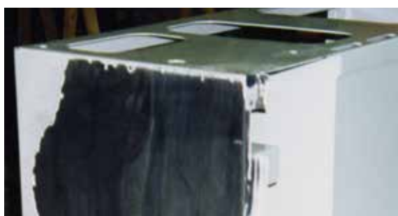
Fig. 2.3.2 La capa de polvo se desprende por completo
