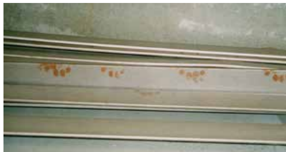
Fig. 3.8.2 Contaminación debida al sudor de las manos, la crema de manos, etc
