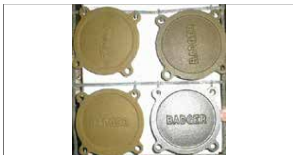
Fig. 1.3.6 Corrosión de piezas tratadas con chorro de arena tras el pretratamiento
