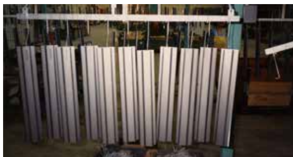
Fig. 2.4.2 Posicionamiento incorrecto de las piezas de trabajo
