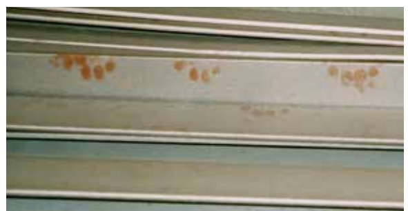
Fig. 3.2.6 Huellas dactilares de la crema de manos
