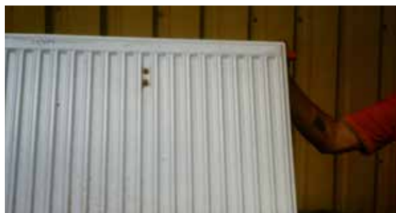
Fig. 5.2.2 Pretratamiento inadecuado o insuficiente
