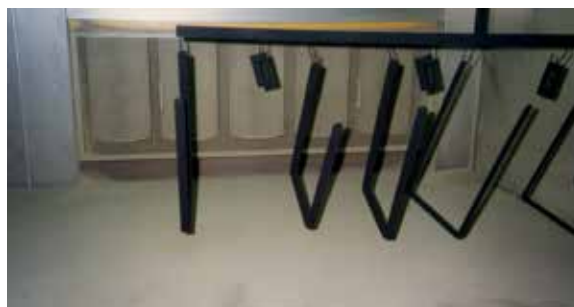
Fig. 6.1.2 Transferencia potencial de polvo de una cabina a otra; contaminación cruzada
