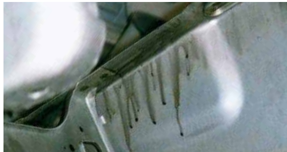
Fig. 1.3.2 Lubricantes de estampacion resistentes al pretratamiento
