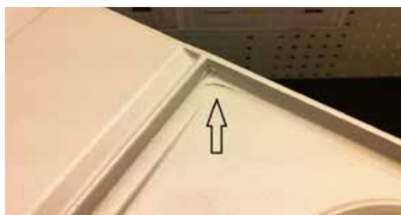
Fig. 3.7.2 Acumulaciones de recubrimiento en polvo en esquinas debido a que el polvo ha goteado por fuera de éstas
