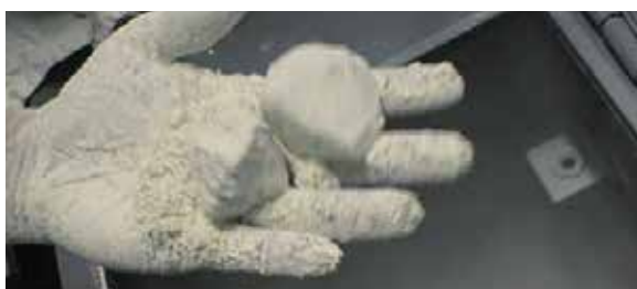
Fig. 2.5.1 Apelmazamiento en caja
