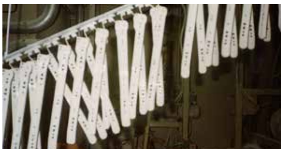
Fig. 2.4.1 Posicionamiento incorrecto de las piezas de trabajo
