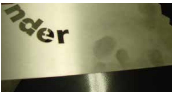
Fig. 3.2.5 Huellas dactilares por debajo del barniz
