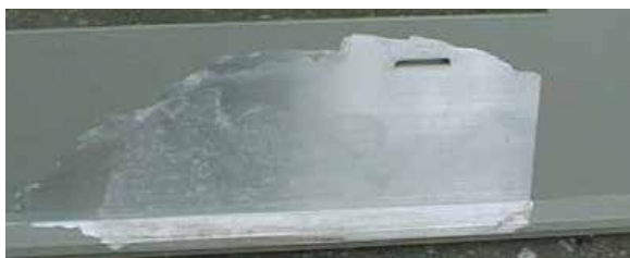
Fig. 1.1.1 Pretratamiento de cromatizado de conversión pobre
