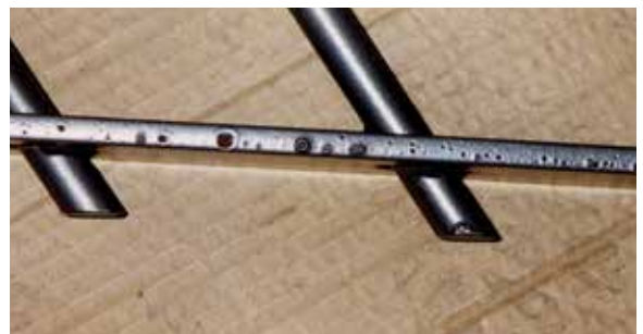
Fig. 3.2.4 Cráteres en capa de recubrimiento en polvo debido a la corrosión
