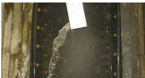
Obr. 1.3.7 Možný přenos média předúpravy z jedné lázně do jiné lázně
