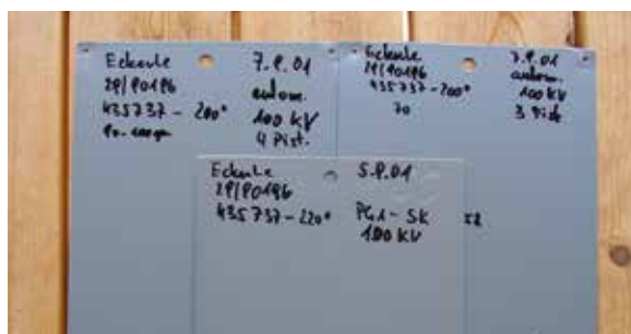
Obr. 7.2.1 Oddělování báze od metalických pigmentů v důsledku recyklace Obr. 7.2.2 Změna výrobních partií prášku v průběhu práškování
