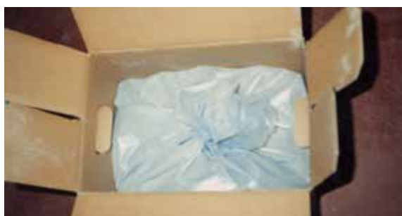
Obr. 3.5.6 Znečištění při skladování práškového laku
