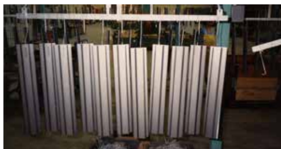
Obr. 2.4.2 Nesprávné zavěšení dílů v lakovacím boxu
