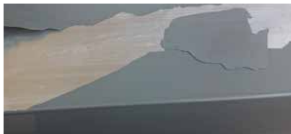
Obr. 1.1.5 Konverzní vrstva je příliš silná
