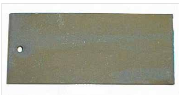
Obr. 1.3.5 Koroze následkem ošetření Fe-fosfátem na pískovaných dílech
