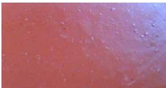
Obr. 3.5.3 Nečistoty v prášku povahy vláken
