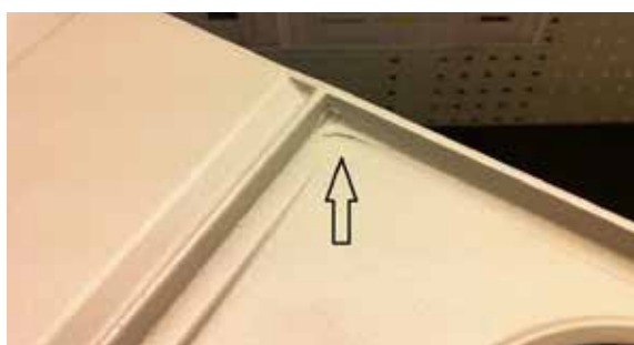
Obr. 3.7.2 Hromadění práškového laku v rozích v důsledku
