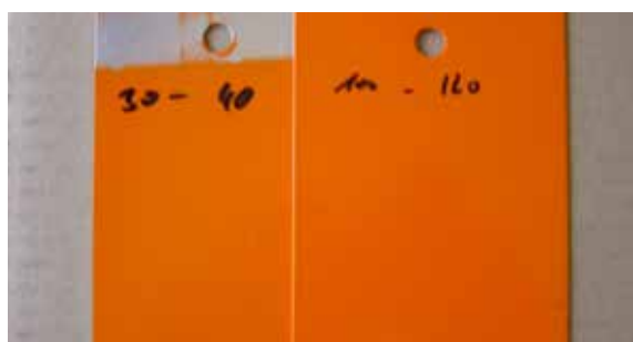
Obr. 4.1.2 Vrstva laku příliš tenká a nekryje
