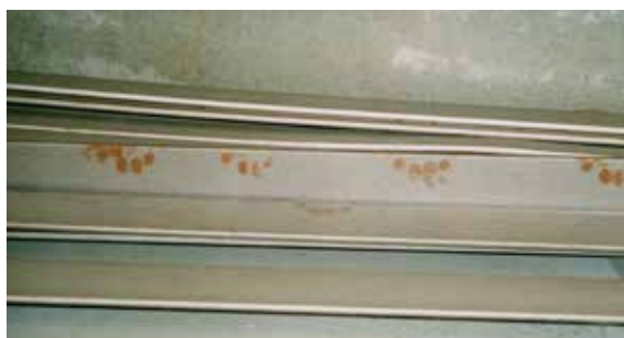
Obr. 3.8.2 Znečištění potem z rukou, krémem
