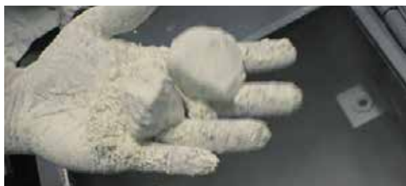
Obr. 2.5.1 Shlukování prášku v obalu-vznik hrudek
