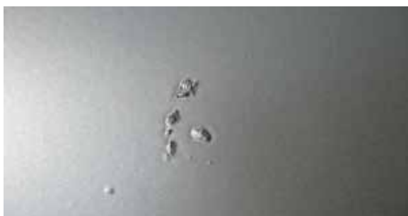
Obr. 3.1.1. „Plivance“ metalického pigmentu
