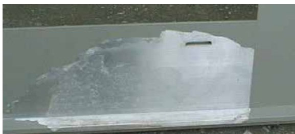
Obr. 1.1.1 Nedostatečné (žádné) chromátování Obr. 1.1.2 Flekaté chromátování
