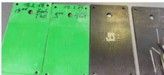
Obr. 1.1.4 Konverzní vrstva není dostatečně silná.
