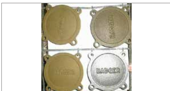
Obr. 1.3.5 Koroze následkem ošetření Fe-fosfátem na pískovaných dílech
