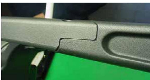
Obr. 7.3.1 Světlé – tmavé odchylky na lakovaném dílu
