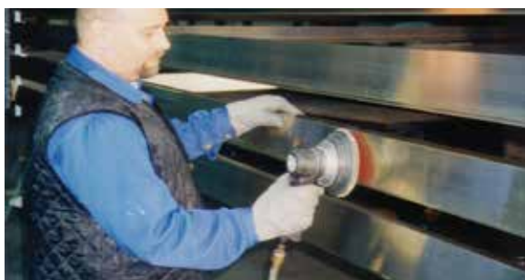
Obr. 3.5.1 Znečištění lakovaného povrchu částicemi z broušení a z pracovních oděvů
