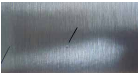
Obr. 3.5.7 Částice gelu v práškovém laku
