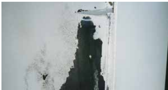
Obr. 2.3.1 Části vrstvy prášku odpadá
