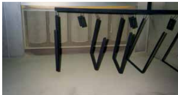
Obr. 6.1.2 Možný přenos prášku z jedné kabiny do druhé
