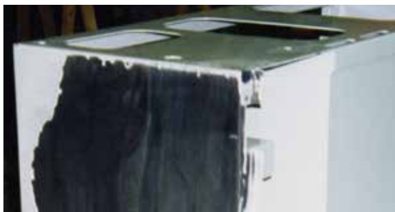
Obr. 2.3.2 Celé vrstvy prášku odpadávají
