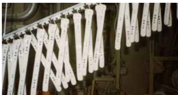
Obr. 2.4.1. Nesprávné zavěšení dílů v lakovacím boxu
