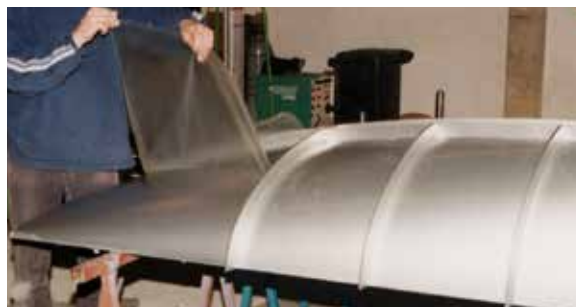
Obr. 5.2.4 Žádná nebo slabá přilnavost mezi vrstvami
