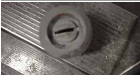
Obr. 2.2.1 Příliš velký tlak dopravního stlačeného vzduchu, na ploché koncovce se prášek usazuje Obr. 2.2.2 Poměr jemných částic v práškovém laku je příliš vysoký, prášek ulpívá na talířové koncovce
