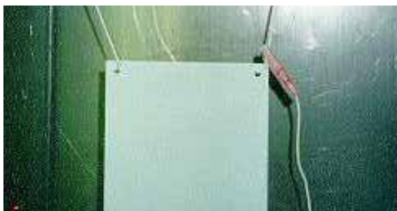
Obr. 2.3.3 Chybí uzemnění nebo je nedostatečné
