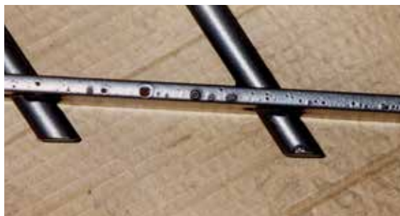
Obr. 3.2.4 Krátery ve vrstvě práškového laku způsobené korozí
