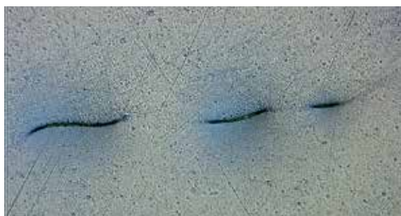
Obr. 3.5.2 Vlákna, cupanina z hadrů použitých při čištění
