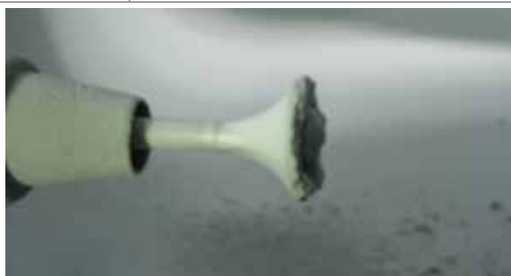
Obr. 2.2.1 Příliš velký tlak dopravního stlačeného vzduchu, na ploché koncovce se prášek usazuje Obr. 2.2.2 Poměr jemných částic v práškovém laku je příliš vysoký, prášek ulpívá na talířové koncovce
