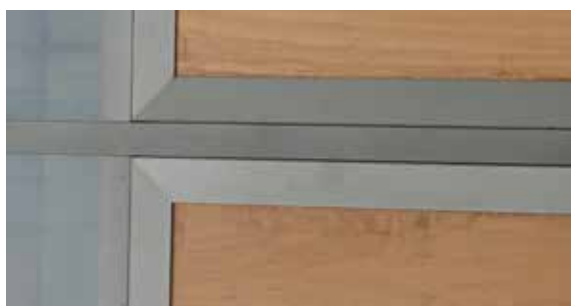
Obr. 7.2.1 Oddělování báze od metalických pigmentů v důsledku recyklace Obr. 7.2.2 Změna výrobních partií prášku v průběhu práškování
