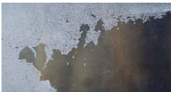
Obr. 3.8.1 Velká nepokrytá místa, na kterých chybí vrstva práškového laku na ruce, ...
