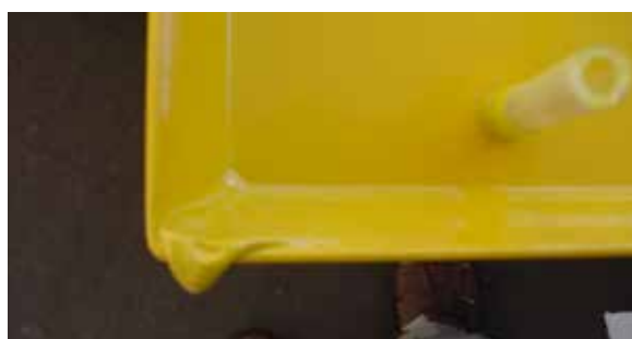
Obr. 3.7.1 Tloušťka vrstvy příliš vysoká sesypaného prášku
