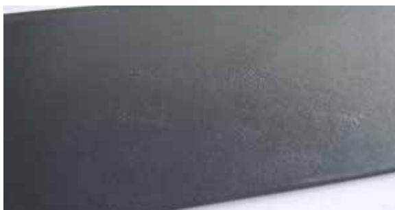
Obr. 3.2.7 Opískování nedokonale opláchnutého dílu s KTL základním lakem
